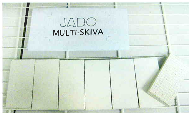
Figur 1. JABO Wood Products testade Multi-skiva. Resistensprovningen gjordes på den släta sidan av provbiten.
